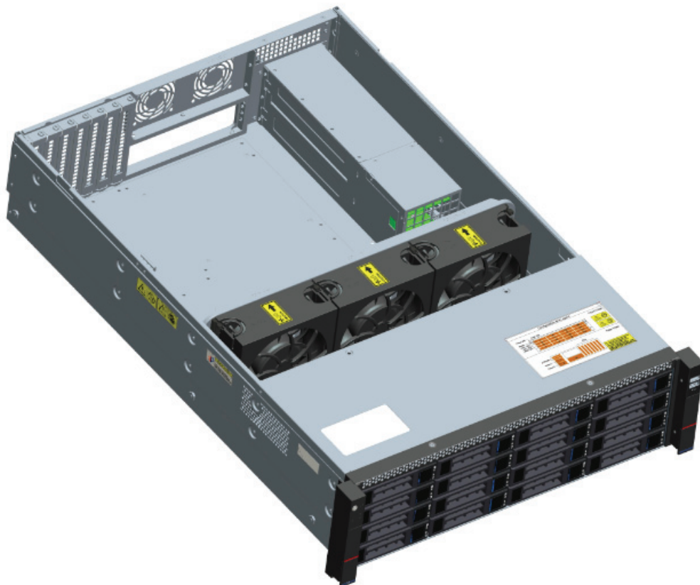
(3) 最终 3 个风扇模组安装完成效果图。
